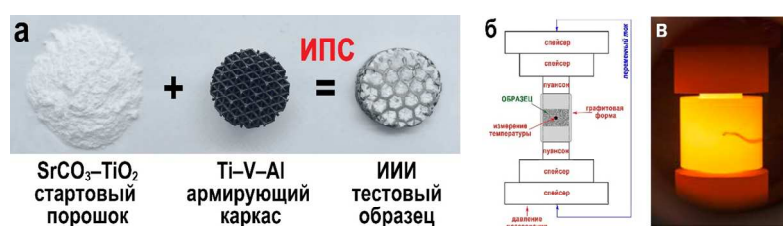
Рис. 4.1. Общая схема получения тестового изделия ИИИ-открытого типа по технологии реакционного ИПС: а – заготовки и конечное изделие; б – схема ИПС процесса; в – разогрев пресс-формы с образцом
