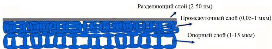
Рис. 5.2. Схематическое изображение структуры керамической мембраны
